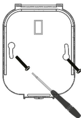
Inserte los tornillos de fijación a través de los orificios de montaje de la base de potencia y apriéte los.
